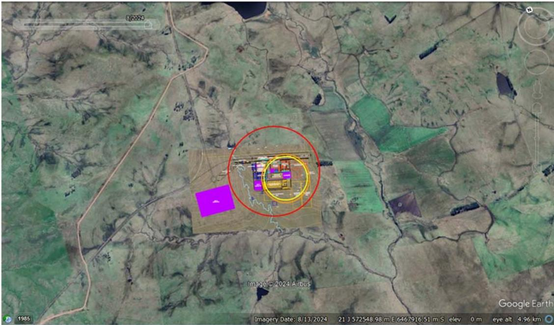
Figura 7-8 Histograma con centro en la ubicación propuesta proyecto con mayores distancias de efecto daño personas de 650m (rojo – incendio BLEVE de MeOH), daño edificios 300m (naranja – explosión de GH2) y daño equipamiento 280m (amarillo – explosión de GH2).
