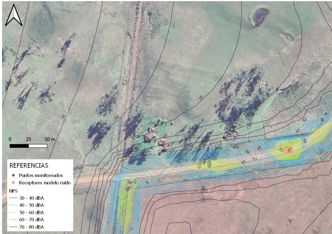
Figura 6-5: Resultados de la modelación de nivel de presión sonora en el entorno del receptor V01 – Escenario con tránsito.
