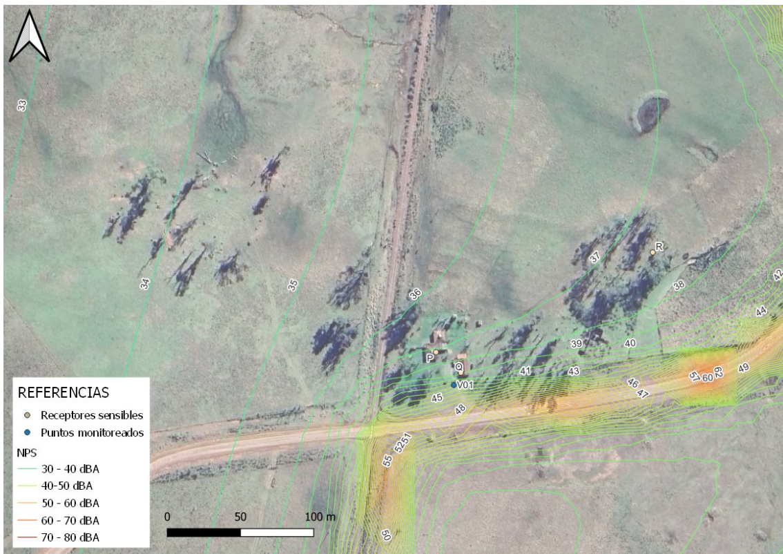
Figura 6-1: Resultados de la modelación de nivel de presión sonora en el entorno del punto V01 – Escenario con tránsito.
